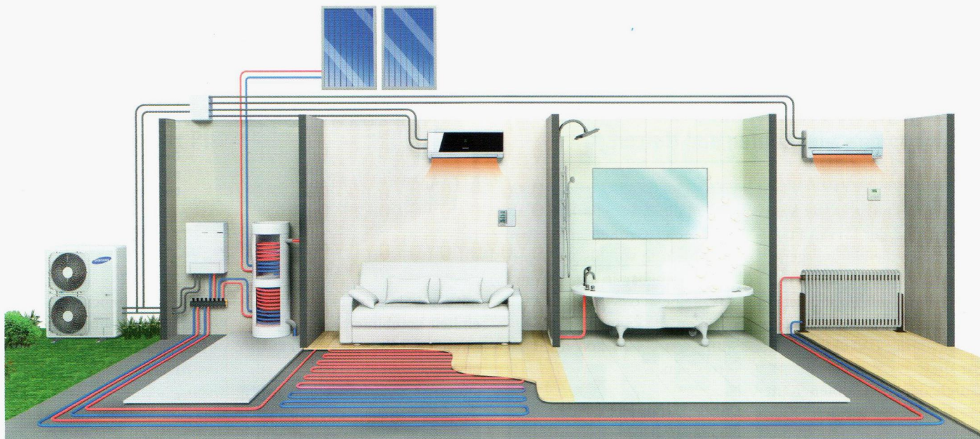
bösch Calida Eco Dual TDM von Samsung ist ein „all-in-one“-System mit einer hocheffizienten Wärmepumpen-Technologie. Es bietet verschiedene Kombinationslösungen aus Luft und Wasser zum Heizen oder Kühlen.
