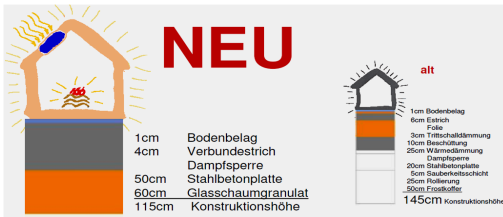
Abb. 2-29: Bauteilaktivierung - Systemgegenüberstellung (Ferle, 2008)
